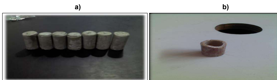
Figura 6. a) Probetas bajo las Normas ASTM D695 b) Buje de 25.4 mm de diámetro maquinado en equipo CNC del Instituto Tecnológico Superior de San Andrés Tuxtla. (Fuente Propia, 2016).
