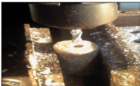
Figura 5. Maquinado de bujes de 25.4 mm de diámetro en PET reciclado. (Fuente Propia, 2016)).
